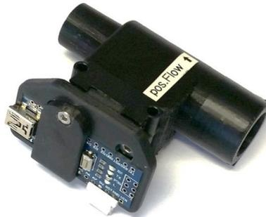
Abbildung 5: Abbildungen des realisierten Differenzdruck-Durchflusssensors
