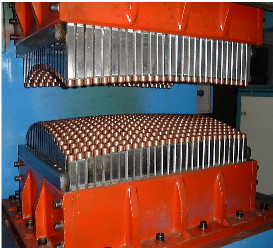
Abbildung 1: Prototyp einer Vielstempelpresse, Jilin University in China. ( http://articles.sae.org/3795/ )
