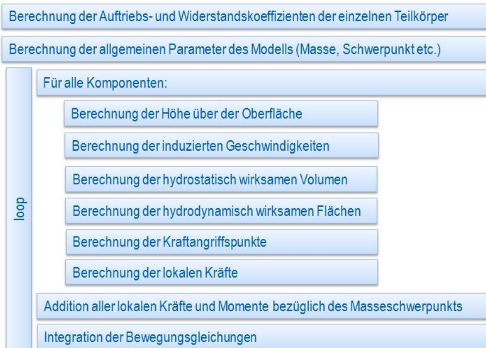
Abbildung 11: Prinzip der Berechnung des Multikomponentenmodells
