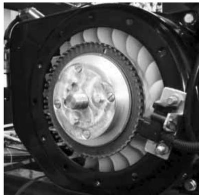
**Abbildung B.1:** 60-2 Geberrad und Hallsensor zur Drehzahlerfassung
