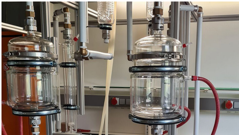
Pilotanlage zur separierenden Trägerdampfdestillation. Quelle: Hochschule Wismar
