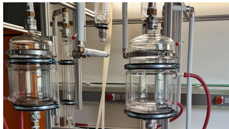
Pilotanlage zur separierenden Trägerdampfdestillation. Quelle: Hochschule Wismar
