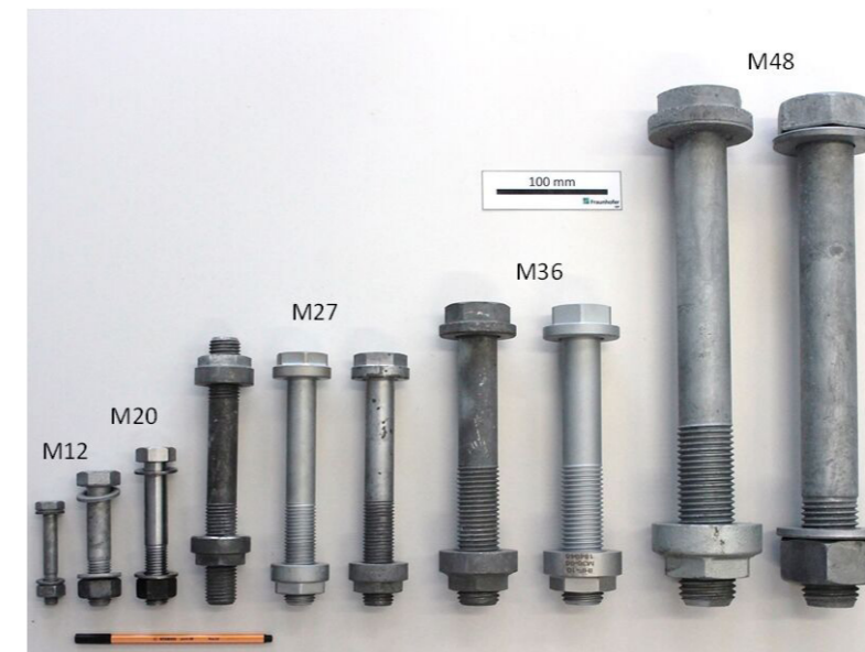
HV-Schraubengarnituren sowie eine Maschinenbau-Schraubengarnitur der Nenngröße M12, M20, M27, M36 und M48. Quelle: Glienke et al. „Zur Ermüdungsfestigkeit großer Schrauben im Stahlbau unter Berücksichtigung von Herstell- und Randschichteinflüssen – Teil 2: Versuchsergebnisse und Bewertung“. Stahlbau 91, Heft 1, S.20-38, 2022
