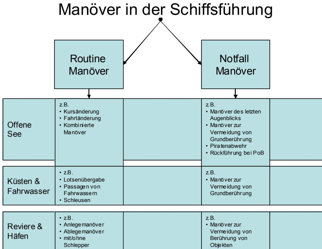
Abbildung 3: Systematisierung von Manövern der Schiffsführung
