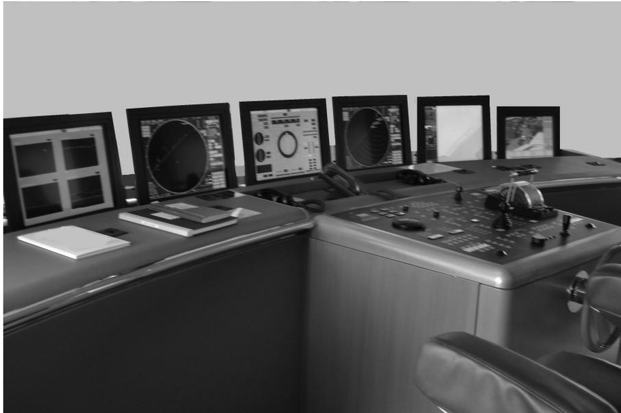
*Beispiel einer Navigationskonsole mit Multifunktionsplätzen und einem Steuerstand mit modularer Bedienplatte*
