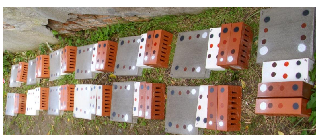
Abb.14: Testfelder mit AGS- und Graffiti-Farbauftrag
