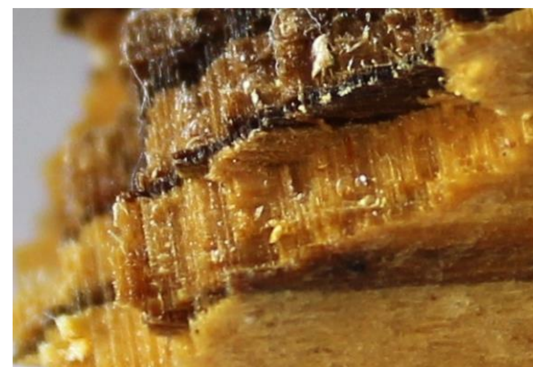
Abb. 7 Kurzfasriges Bruchbild von wachsmodifiziertem Holz nach Lagerung in Königswasser
