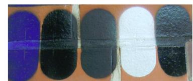
Farbauftrag auf Probekörper
