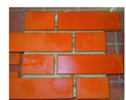
verklebte Ziegelriemchenfertige Probekörper
