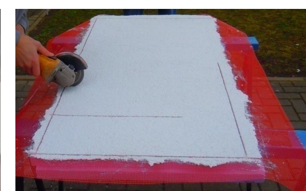
Zuschneiden der Prüfkörper
