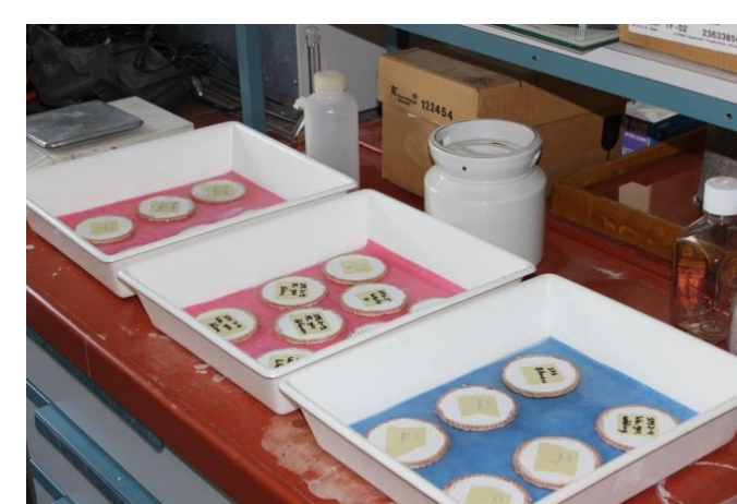
teilweises Eintauchen der Putzproben
