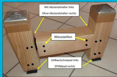
Abb. 1 Prototyp des Prüfkörpers
