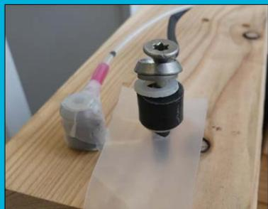
Abb. 5 Abdichtung der Messelektroden mit Parafilm stellte sich als nicht ausreichend wasserdicht heraus
