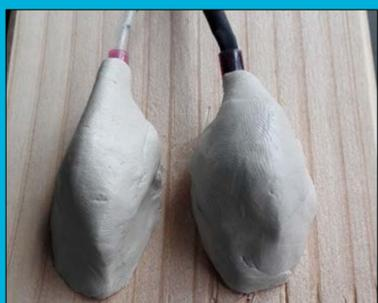
Abb. 6 Ausreichende Abdichtung der Messelektroden mit Plastic-Fermit
