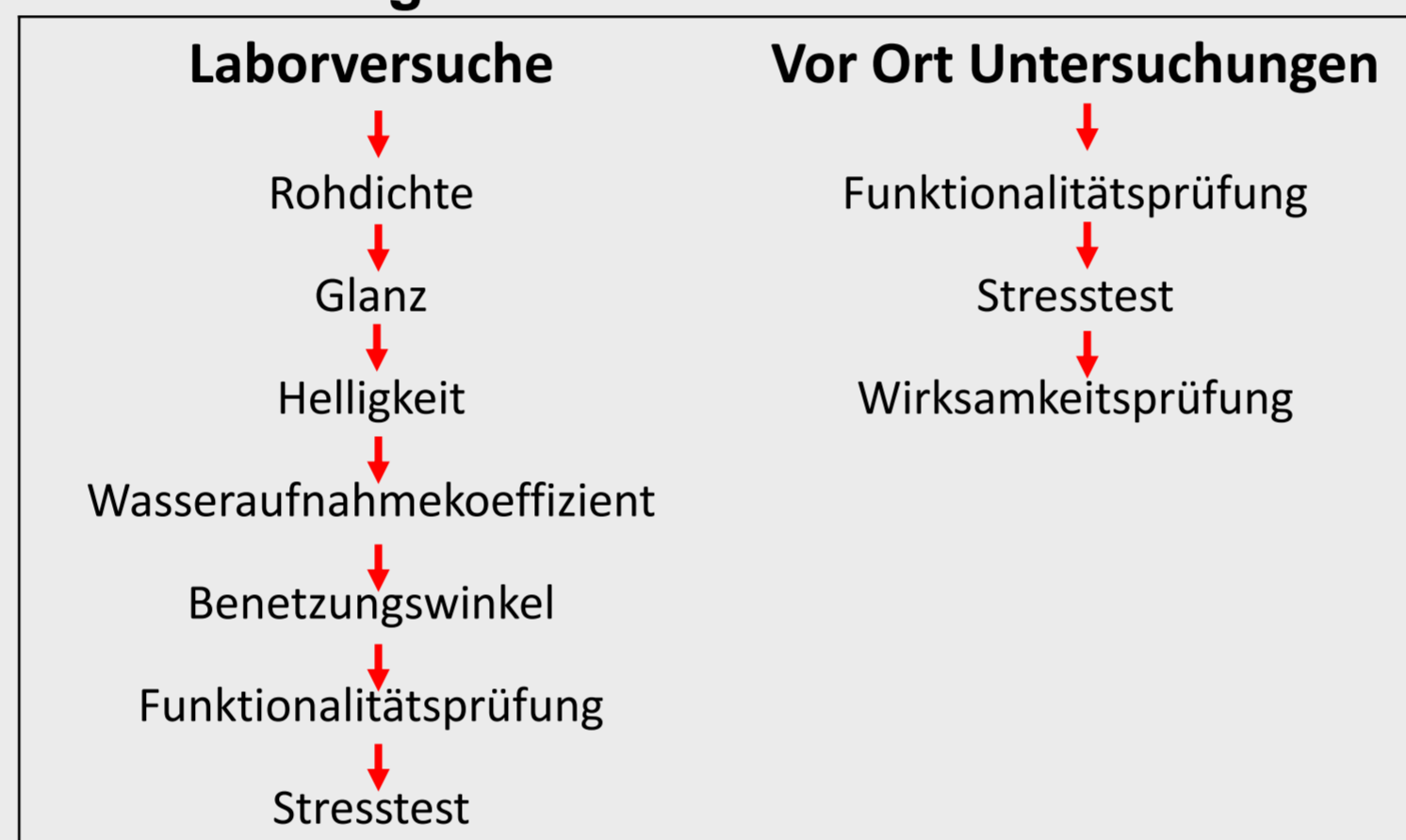
Abb. 2: Durchführungsschema der Labor- und vor Ort Untersuchungen
