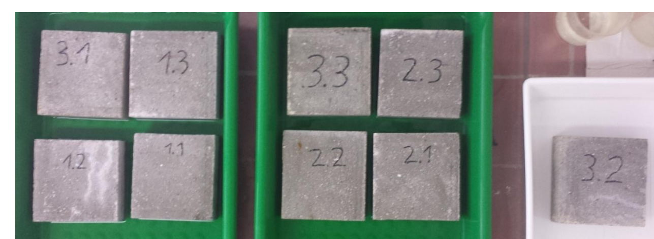
Bild 10: Bestimmung der Wasseraufnahme (w-Wert) an Referenz- und mit AGS behandelten Prüfkörpern
