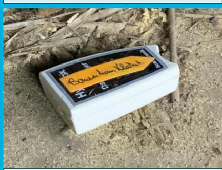
Abb. 1: Datenlogger für Temperatur- und relative Luftfeuchtemessung
