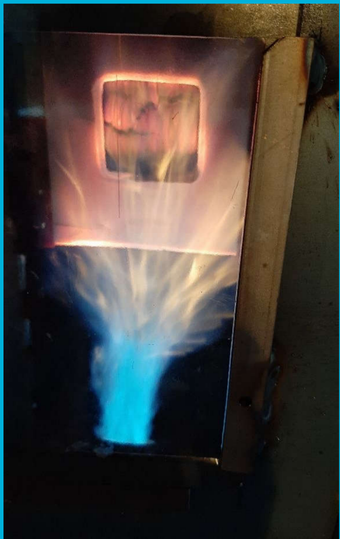
Bild 2: Ansicht Beflammung einer Holzprobe
