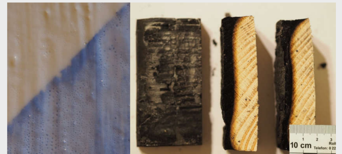
Bild 6: Bläschen auf einem mit mineralischer Farbe beschichteten Probekörper
