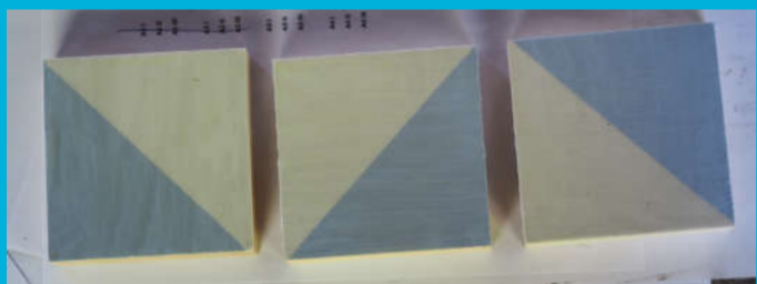
Bild 3: Prüfkörpercharge vor dem Brandversuch
