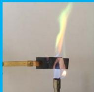
Bild 7: Beilsteinprobe
