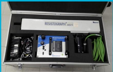
Abb. 4: Bohrwiderstandsmessgerät
