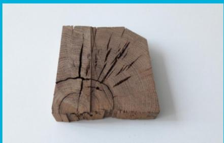
Abb. 5: Prüfkörper, darrtrocken
